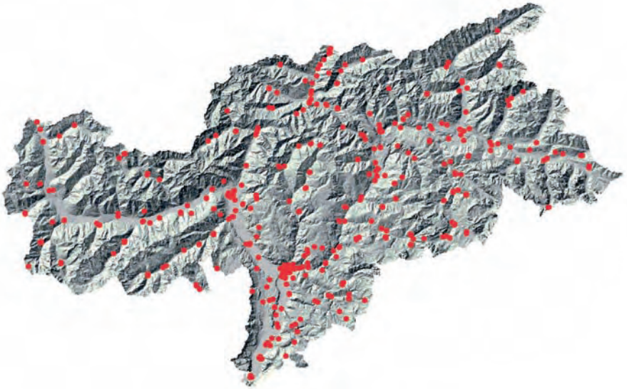
BILD 5) zeigt die Verteilung der Basisstationen für den Mobilfunk in Südtirol.
